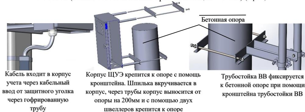
Кабель входит в корпус учета через кабельный ввод от защитного уголка через гофрированную трубу
